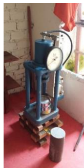
Inspección al ensayo de resistencia a los cilindros de concreto
