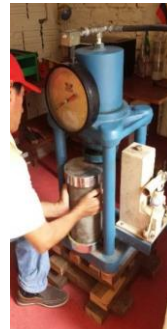
Inspección al ensayo de resistencia a los cilindros de concreto
