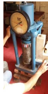
Inspección al ensayo de resistencia a los cilindros de concreto
